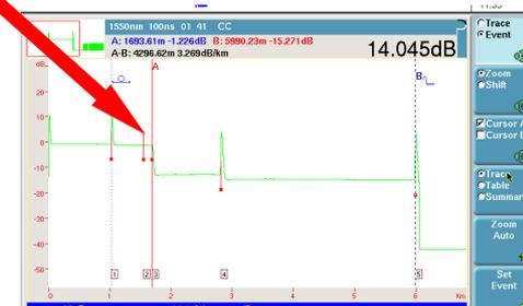
*Сплиттера на разъемах имеют более высокие значения Вносимых потерь, чувствительны к грязи и более дорогие. OTDR измерения (длина, события, погонное затухание/км, вносимые потери, ORL) на 1310 и 1550нм; 1490 нм не требуется*
